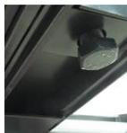
Болт для регулировки угла наклона вил способствует лучшему захвату грузов.
