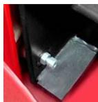
Регулировка роликов каретки позволяет сократить износ рамы и роликов.
