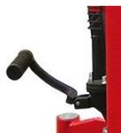
Гидравлическая система приводится в действие рычагом или ножничной педалью.
